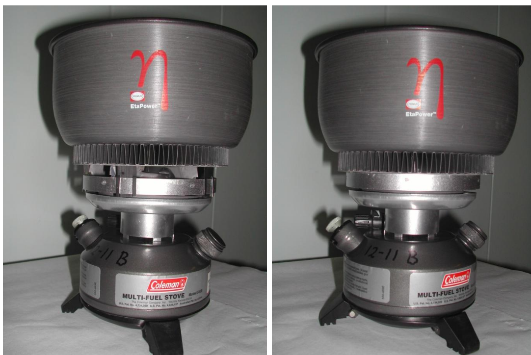
Figur 3.5 Kjelen med varmeveksler (EtaPower™) kan plasseres på Coleman Multifuel mod. 550 på to måter, til venstre er den satt på finnene (høy stilling) og til høyre er den presset ned slik at den står støtt på kokeapparatet (lav stilling).
