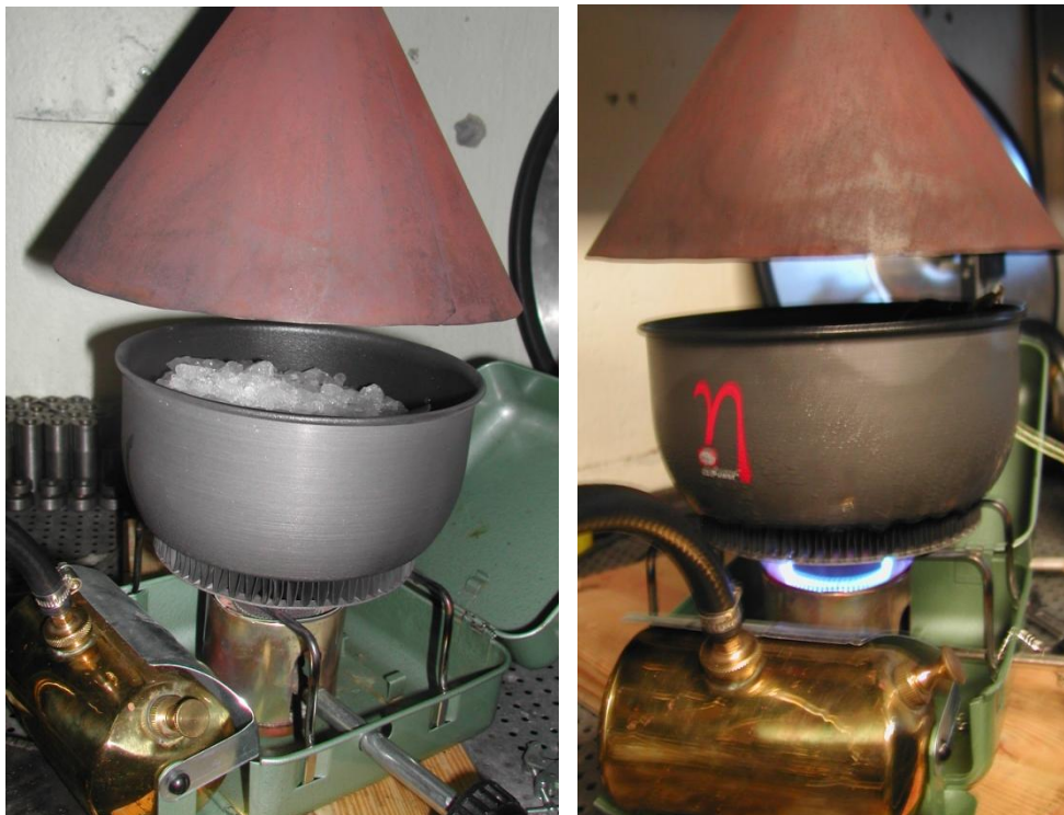
Figur 1.2 Kjelen med varmeveksler(EtaPower™) med is plassert på kokeapparatet Optimus 111 med en trakt over til å fange opp avgassene for analyse. Isen sees i kjelen til venstre og flammebildet under kjelen sees til høyre.
